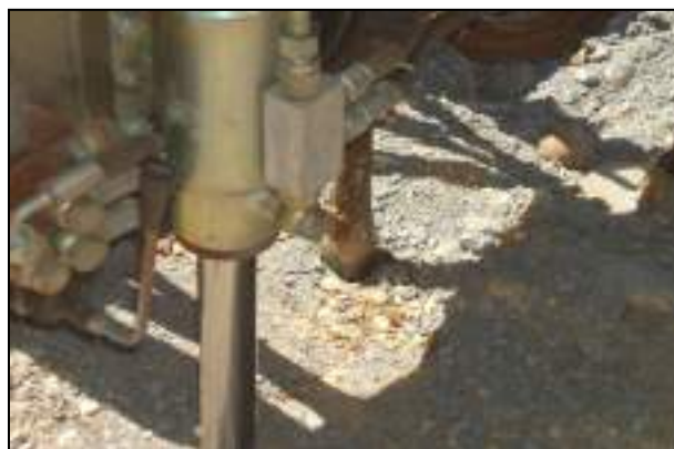
Figura 26: Il dispositivo di infissione della punta
