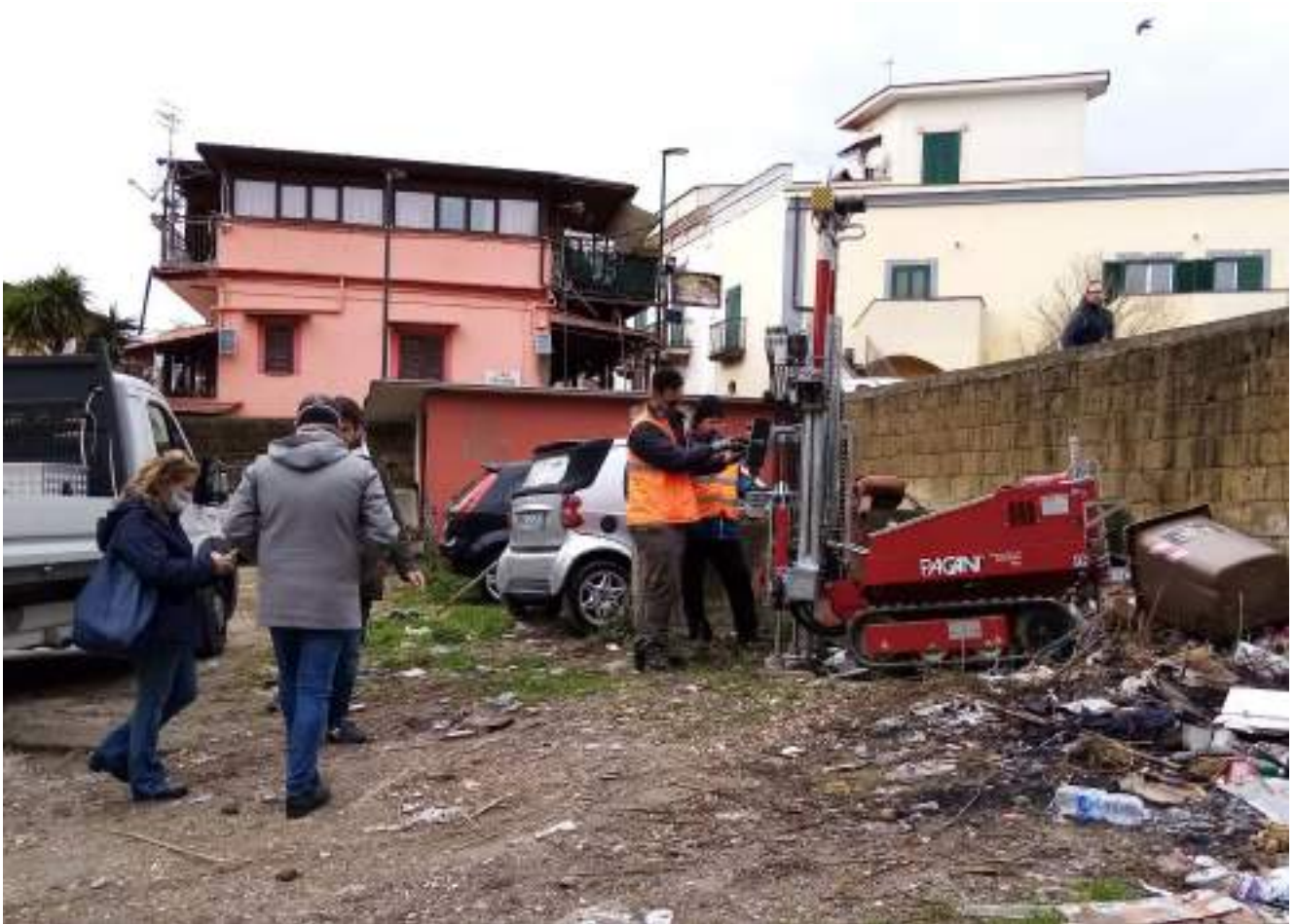
Figura 27 – esecuzione della prova DPSH nell'area in esame, con penetrometro Pagani.
