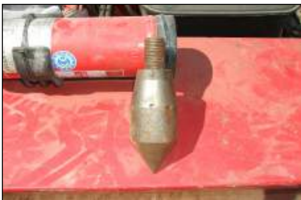
Figura 25: La punta conica utilizzata per l'esecuzione delle prove DPSH
